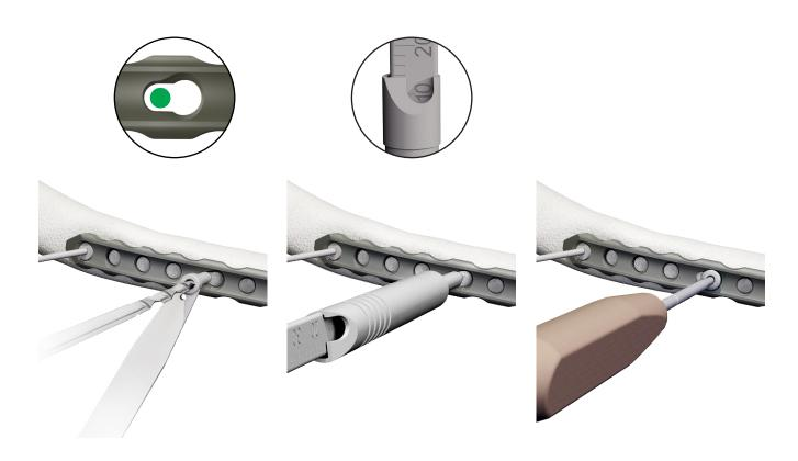
Entsprechend der gemessenen Länge mit der Schraubenlängenmesslehre, Solide Kleinfragmentschrauben (59022) wird nun eine D=3.5mm Kortikalisschraube (3235I-XX) mit dem Schraubenzieher, SW 2.5 (56252) eingebracht.
